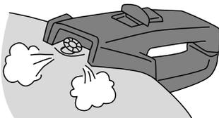
↑アロマビーから蒸気が出続けていつまでもとまらないときは、火をとめ、アロマビーに付着物がないか、圧力調整装置がきちんと装着されているか、ゴムパッキンから蒸気もれがおきていないかを点検します。
